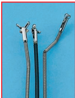
Pense de biopsie deteriorate prin forțe de încovoiere
