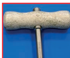
Deterioare doar a mânerului din aluminiu. Cauza: Utilizarea unui detergent foarte alcalin
