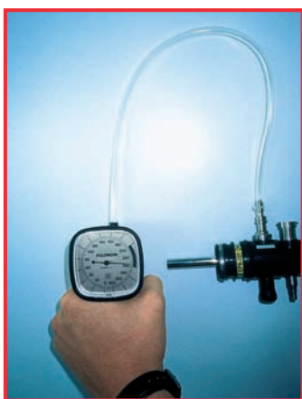
Test manual de etanșare pentru un endoscop flexibil
