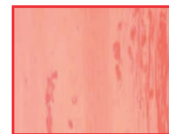
Deteriorarea suprafeței de aluminiu cauzată de utilizarea unui agent de curățare alcalin
