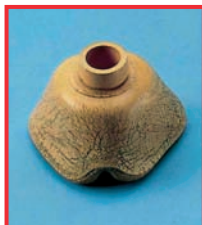
Fisuri cauzate de îmbătrânire pe o mască de respirație
