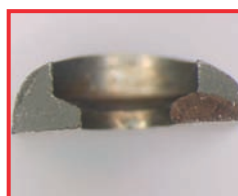
Ruptură la șuruburile cu cap înecat
