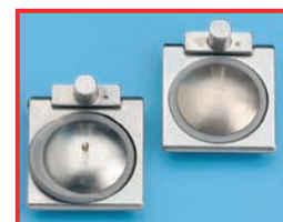
Supapă nestrânsa de trocar cauzată de umflarea garniturii ca urmare a contactului cu uleiul
