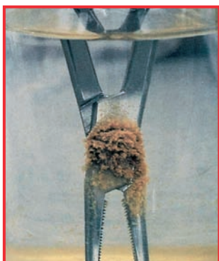
Coroziune cauzată de imersarea în soluție de ser fiziologic pe o perioadă de câteva ore
