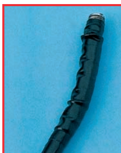
Umflare într-un tub flexibil de inserție cauzată de utilizarea unui agent de curățare necorespunzător
