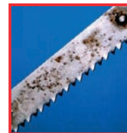
Formare de rugină pe o lama de fierastrău din oțel carbon, neplacată cu crom. Cauza: Defecte în stratul de crom
