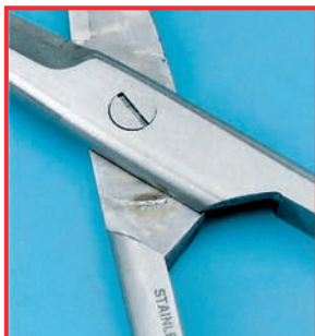
Coroziune prin frecare datorată lubrificării insuficiente
