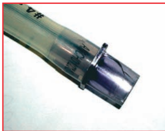
Fisură cauzată de tensiuni
