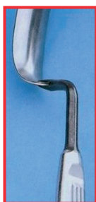
Instrument din aliaj de oțel cu crom și nichel decolorat
