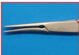
Deformare cauzată de îndoirea necorespunzătoare a extremităților articulate
