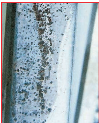
Depuneri pe un instrument, formate de substanțe cu conținut de cloruri
