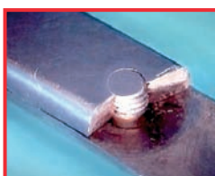
Foarfecă cu ruptură în jurul balamalei
