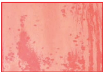
Schimbări de culoare ale suprafețelor de aluminiu anodizat interven chiar și în prezența unor soluții medii alcaline.
