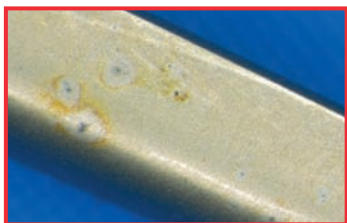
Puncte de coroziune induse de cloruri pe un instrument
