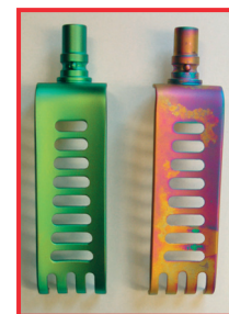
Valva stânga: obținut din fabricație, uniform vopsită în verde, valva dreapta: curățată mecanic, iridizată
