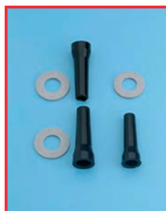
Garnituri umflate ca urmare a aplicării incorecte de ulei
