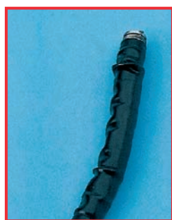
Umflare la capătul distal al unui fibroscop
