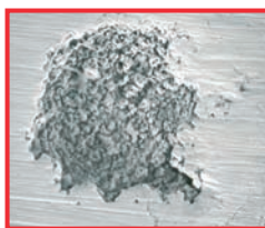
Gaură de coroziune mărită la microscop (200x)
