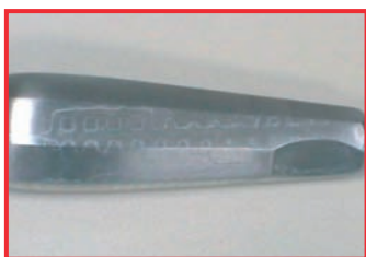
Reziduuri de agenți de curățare cauzate de o clătire insuficientă
