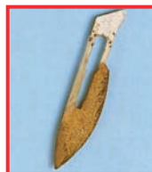
Formare de rugină pe lama unei dălți. Cauza: nu este din oțel inox, produsul este de unica folosință.
